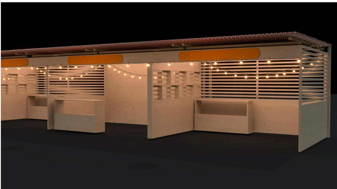
3.3 Balcão frontal estruturado em madeira com acabamento frontal em esteira de palha ignifugada, com tampo com pingadeira, e divisória lateral estruturada em madeira. Comunicação visual em mdf com impressão direta com recorte em formato especial e
