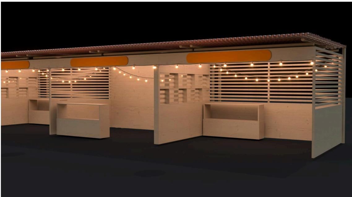
3.3 Remontagem e manutenção necessária para Barracas de Comida com Preparo máscara frontal para estrutura de octanorme, composta de saia estruturada em madeira com acabamento frontal em esteira de palha ignifugada, colunas laterais construídas e chapeadas
