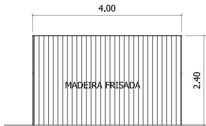
VISTA PAREDE DE FUNDO
