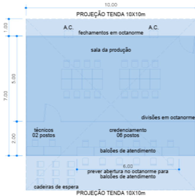
PRODUÇÃO E CREDENCIAMENTO PLANTA ESCALA 1:100 01 TENDA 10x10m PREVER SISTEMA DE PISO ELEVADO NA ÁREA FECHADA DE octanormeE ÁREA TOTAL DE PISO ELEVADO: 70m 2
